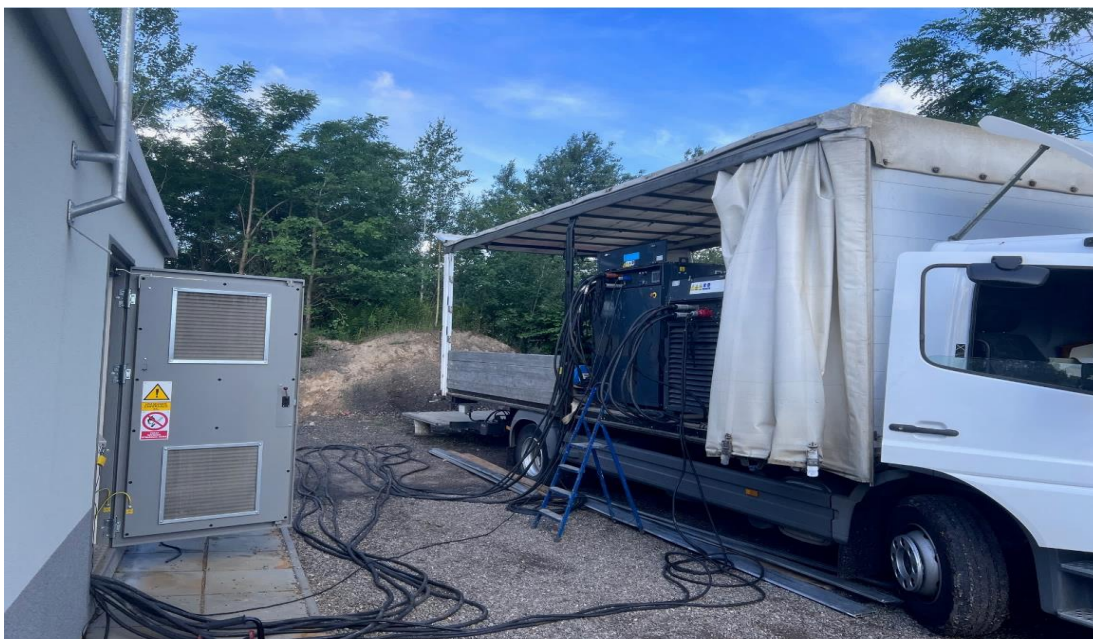
Rys. 7. Testy mikrosieci z wykorzystaniem sztucznego obciążenia
